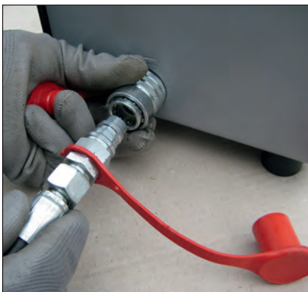
Einfaches Anschließen des Hydraulikschlauchs per Schnellverschluss Hydraulic hose is easily attached using the quick-lock system
